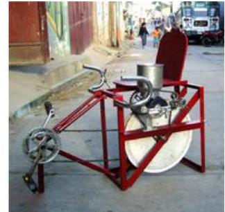
Las bici-maquinas producidas por *Mayapedal* son máquinas impulsadas con fuerza de pedales, obteniendo una capacidad más elevada que la manual. Se construyen reciclando partes de bicicletas inutilizadas y otros materiales locales, como concreto, madera y metal.
