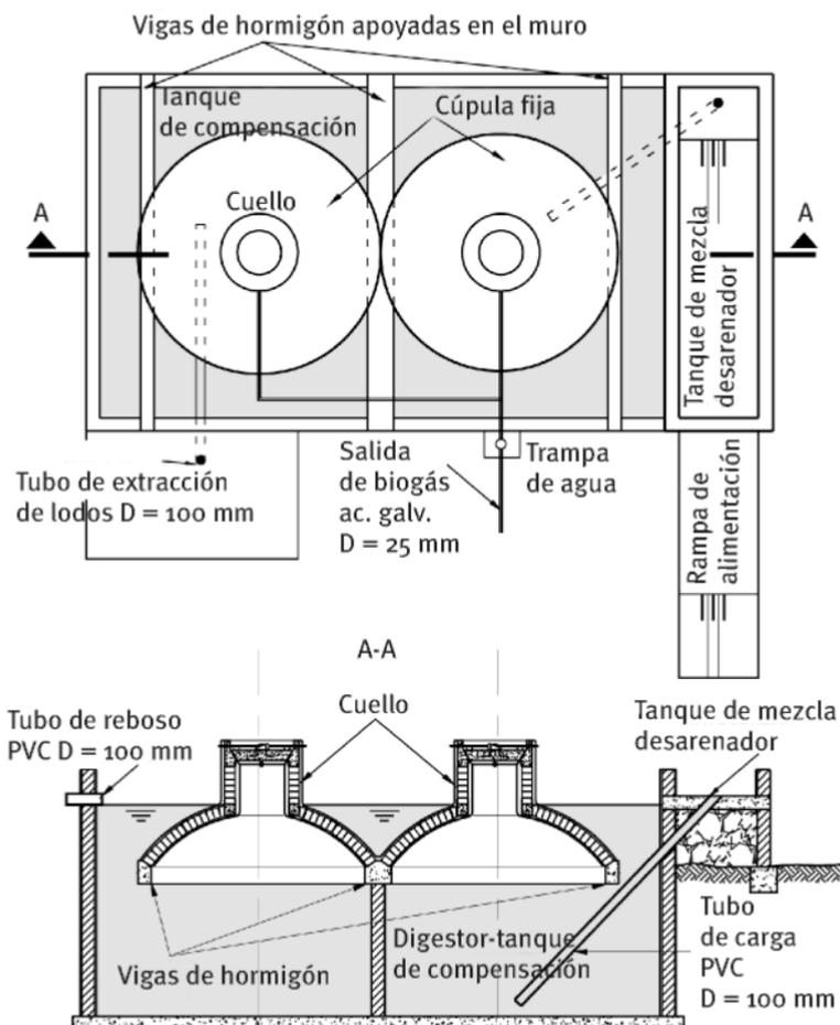
Fig. 18. Planta de biogás del tipo GBV desarrollado y adecuado al entorno con materiales de construcción convencionales, a partir de una fosa en deshuvo enclavada en el lugar. Este biodigestor de 20 m<sup>3</sup> de capacidad, instalado en enero de 2006, fue concebido para satisfacer la cocción de alimentos que se le suministran a los animales que se enferman en el zoológico de Santa Clara, Villa Clara. Esta obra fue ejecutada con esfuerzos propios.
