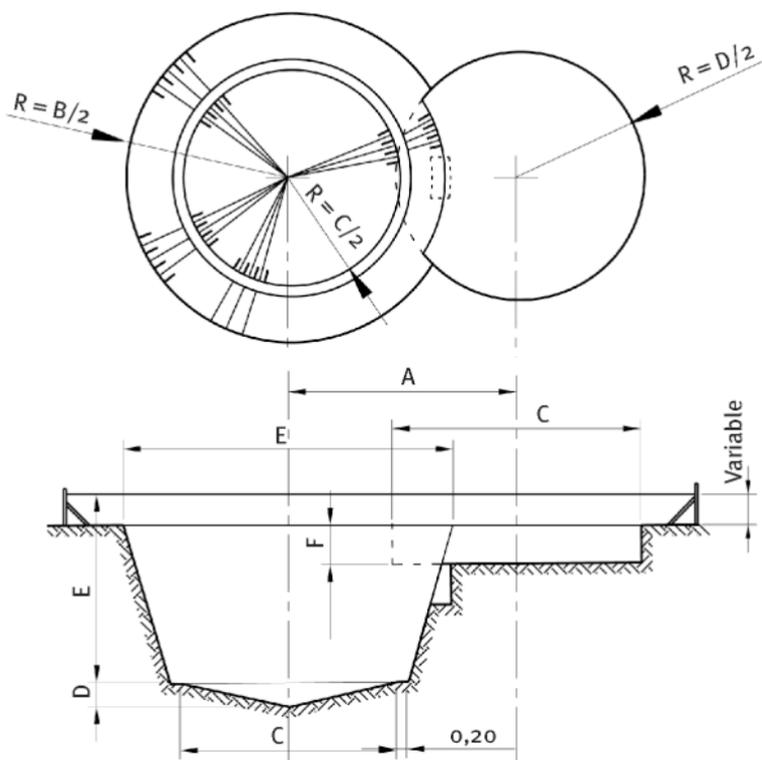
Fig. 2. Planta y corte de la excavación para biodigestores típicos del tipo Nicarao, desde 12 hasta 42 m<sup>3</sup>.
