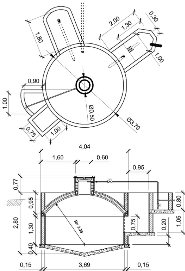
Fig. 24. Diseño del tipo GBV adecuado al entorno con materiales convencionales de construcción en la presa Margarita, a 5 km del poblado de Jicotea, Ciego de Ávila. Esta planta de biogás de 22 m<sup>3</sup> se concibió para satisfacer la cocción de alimentos de los trabajadores que allí laboran y de la familia de la vivienda que tiene a su cargo la custodia de la presa. Esta obra fue ejecutada con esfuerzos propios.
