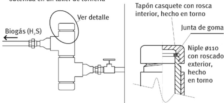
Fig. 10. Montaje de una trampa de ácido sulfhídrico.
