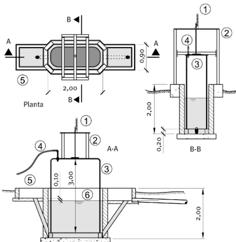
Fig. 21. Diseño atípico, desarrollado a partir de los conceptos de la metodología GBV, aprovechando un casco de transformador eléctrico desechado. Esta planta de biogás de 8 m<sup>3</sup> de capacidad, construida con esfuerzos propios en el municipio de San Cristóbal, provincia de Pinar del Río, fue concebida a partir de la creatividad del usuario, contribuyendo con ello al arte del biogás en Cuba.
