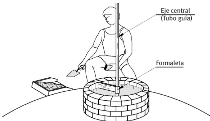
Fig. 13. Ejecución y terminación del cuello típico para una planta de biogás de los modelos Nicaragua y GBV.
