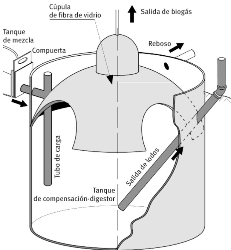
Fig. 20. Diseño fabril del tipo GBV, desarrollado y adecuado al entorno con fibra de vidrio. Esta planta de biogás de 12 m<sup>3</sup> de capacidad, puesta en marcha en el 2001, fue concebida para satisfacer la cocción de alimentos de núcleos familiares de hasta de seis personas, en condiciones de montaña de difícil acceso. Se ubicaron cuatro plantas de este tipo en el municipio de El Salvador, provincia de Guantánamo.
