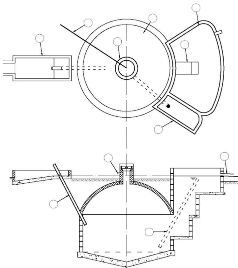
Fig. 27. Diseño típico de cúpula fija concebido con materiales convencionales de la construcción, a partir de la metodología GBV. Esta planta de biogás de 12 m<sup>3</sup> de capacidad ha sido diseñada para satisfacer la cocción de los alimentos de un núcleo familiar de cuatro personas de la unidad 4 en Ciudad Escolar Camilo Cienfuegos del municipio Bartolomé Masó, provincia Granma.
