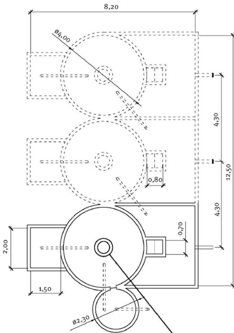
Fig. 26. Diseño típico de cúpula fija, concebido con materiales convencionales de la construcción, a partir de la metodología GBV. Esta planta de biogás de 126 m<sup>3</sup> de capacidad ha sido diseñada para satisfacer la cocción de alimentos de los profesores del Instituto Politécnico Agropecuario No. 8, un consultorio y una vivienda, y posteriormente para el abastecimiento de biogás a la cocina centralizada del ese politécnico de la Ciudad Escolar Camilo Cienfuegos, Bartolomé Masó, Granma.
