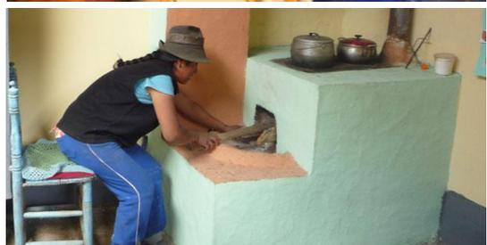
de la cámara de combustión y la parte externa de la cocina no se calienta. Sigue siendo una tecnología de bajo costo porque se puede construir con materiales de la zona y con el apoyo de técnicos y obreros del territorio.
