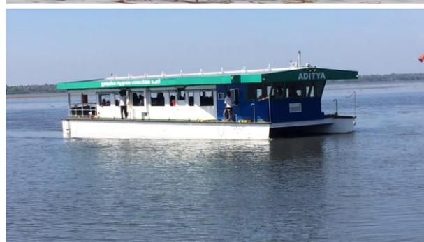
El barco solar de 75 plazas hecho de fibra de vidrio tiene 20 metros de largo y 7 metros de ancho y puede navegar a una velocidad máxima de 7.5 nudos. El barco tiene 78 paneles solares en el techo y un sistema de energía alternativo para emergencias. Aditya navega sin ningún ruido y con una vibración mínima en comparación con los barcos corrientes impulsados por diesel.
