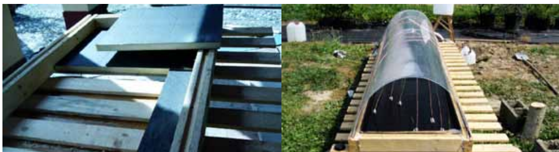
Figura 2. Pasos para la construcción de la solar still con materiales económicos y de fácil adquisición.
