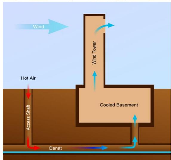
utilizan las corrientes de aire y la evaporación para generar refrigeración y aire acondicionado en las viviendas. Las Torres muestran la compatibilidad de los diseños arquitectónicos construidos por el hombre con el entorno natural y muestran la gran sabiduría de los ingenieros iraníes.
