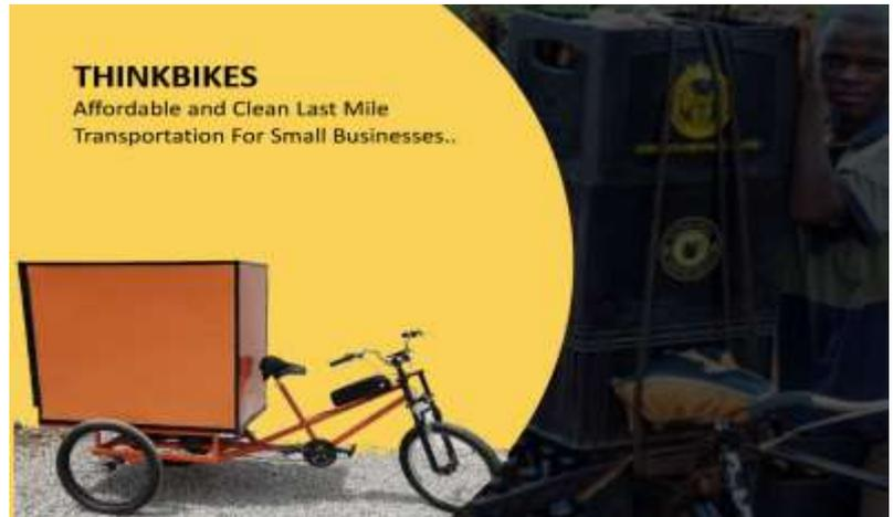
[El vehículo de tres ruedas es una unidad de refrigeración que funciona con paquetes separados y extraíbles de baterías de iones de litio recicladas, extraídas para un segundo uso de ordenadores portátiles viejos.](#) La empresa ThinkBikes ofrece una gama de bicicletas de carga eléctrica, incluyendo los modelos Alpha y Cool Max. Las bicicletas de carga están disponibles para alquiler o para compra.
