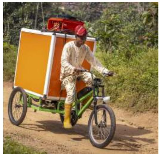
La bicicleta también tiene pedales sincronizados con el motor eléctrico con un sistema de asistencia al pedaleo para permitir al ciclista viajar más lejos con mucho menos esfuerzo. La bicicleta tiene un sistema patentado de recuperación de energía que agrega hasta un 5% de energía a las baterías de tracción, como funcionan los sistemas en los vehículos eléctricos.
