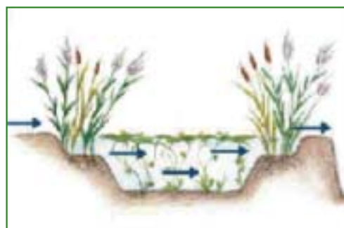
Ilustrim skematik i një sistemi rrjedhjeje nësipërfaqësore horizontale (në mes) të një rrjedhjeje vertikale dhe në fund të një rrjedhjeje të lirë.
